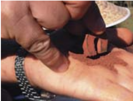
Foto 147 - Utilização do ímã para estimativa do teor de ferro.
