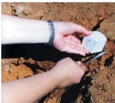
Foto 7 - Detalhe de coleta de amostra indeformada para análise da microestrutura. Simone Ferreira Garcia
