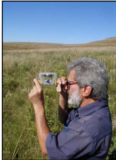
Figura 25c: Medição da declividade do terreno com auxílio de um clinômetro.
