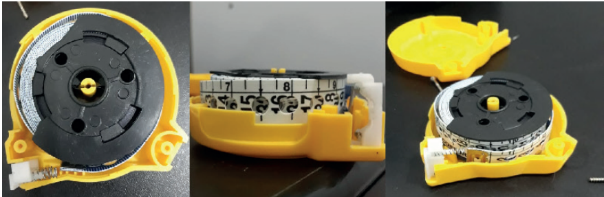
Figura 5 – Vista da fita perfurada dentro do corpo da trena.
