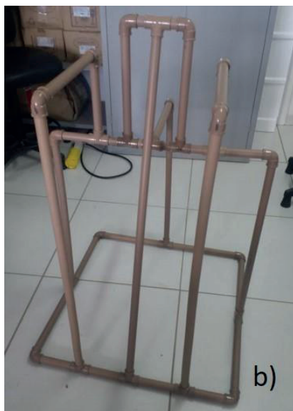
Figura 2- Protótipo de um andador fabricado em tubo PVC.
