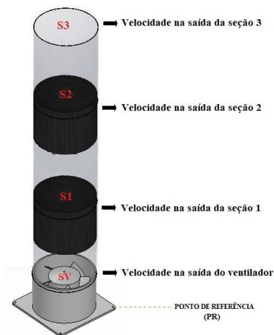
Figura 6 - Pontos de tomada de velocidade.
