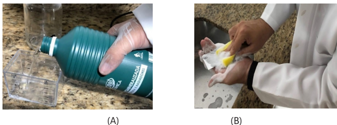
Figura 3 - Início da mistura dos componentes da solução eletrolítica (A), e processo de desengraxe do corpo de prova (B).
