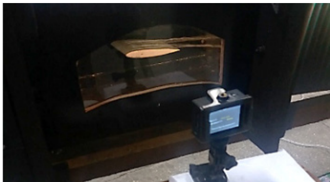
Figura 7: Teste sendo realizado na seção do túnel de vento com o perfil de NACA 0012 e câmera para registro de imagens.
