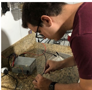
Figura 2 - Início da ligação da fonte ao cátodo.
