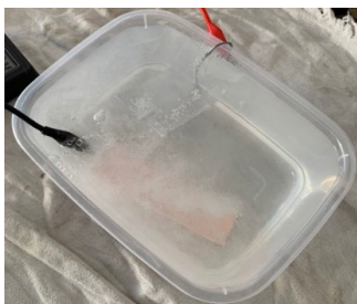
Figura 6 - Diminuição no borbulhamento da solução (A), e finalização do processo de anodização, onde poucas bolhas são visíveis (B).
