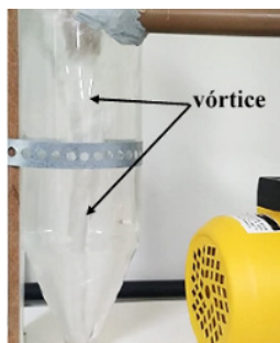
Figura 4 – Vórtice ascendente formado no Hidrociclone H1
