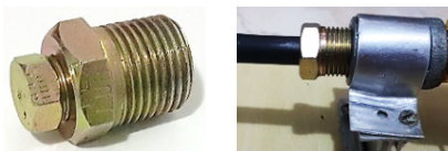
Figura 3 - Plug macho \frac{1}{4} " rosqueado junto a bucha de redução macho x fêmea \frac{3}{4} " (A); Suporte do canhão da extrusora com mancal de deslizamento utilizando bucha de redução de \frac{3}{4} " (B).
