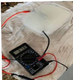
Figura 5 - Borbulhamento no recipiente onde ocorre o processo de anodização.
