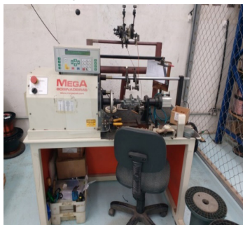
Figura 2: Bobinadeira (A) Visão externa; (B) Visão interna.
