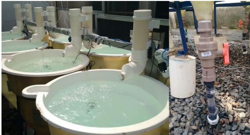
Figura 8 Sistema de alimentação em tempo fixo para determinação do Coeficiente de digestibilidade.
