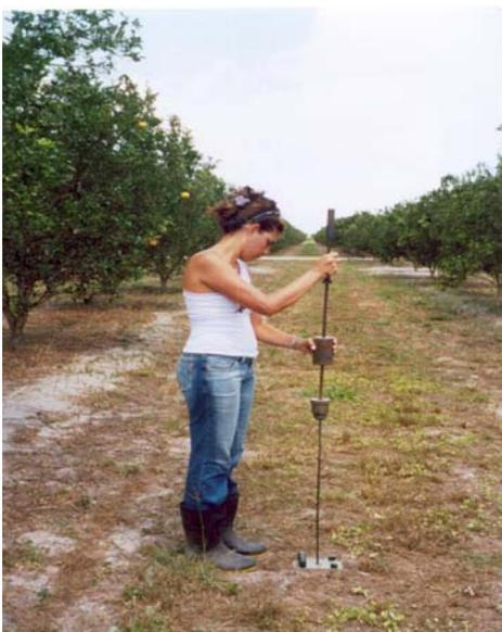
Figura 5 - Penetrômetro de impacto utilizado no ensaio.
