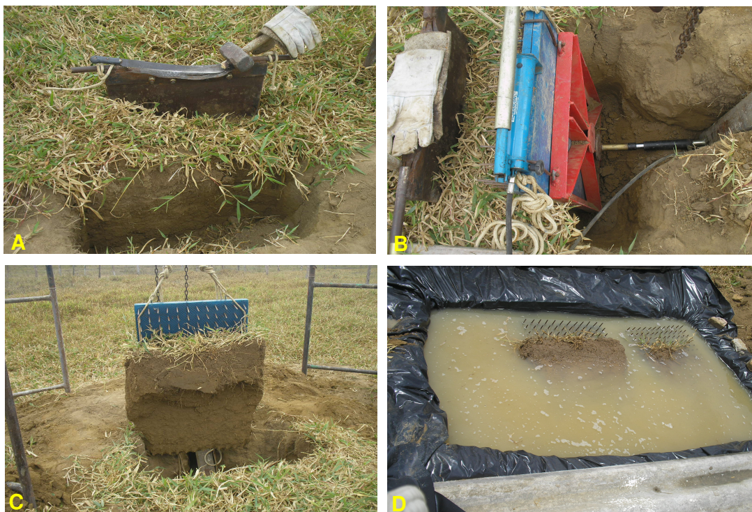
Figura 6 – Amostragem das raízes: A) introdução da guilhotina no solo; B) introdução da prancha de pregos na parede da trincheira, por meio de macaco hidráulico; C) retirada do monólito; D) saturação do monólito para facilitar a posterior remoção da terra com jatos de água de uma torneira, sem causar maiores danos às raízes.
