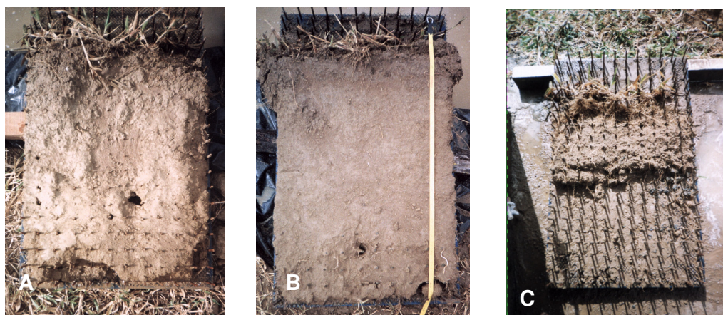
Figura 2 – Monólitos A e B, subparcelas C Sub e test Não sub respectivamente, depois de saturadas por 48 horas. Prancha de pregos C (test Não Sub) mostrando camada coesa.
