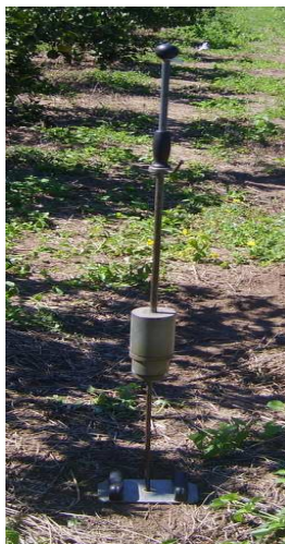
Figura 1. Penetrômetro de impacto utilizado para medir a resistência à penetração do solo.
