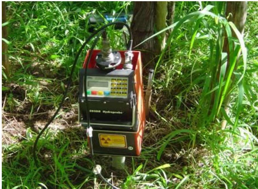
Figura 7. Sonda de nêutrons utilizada para o monitoramento da umidade do solo nas profundidades de 0,15; 0,30; 0,45; 0,60; 0,75; 0,90; 1,05 e 1,20 m.
