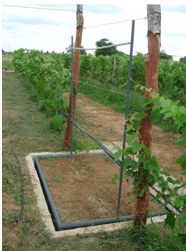
Figura 9 – Lisímetro de pesagem após o plantio da videira e montagem do sistema de condução.
