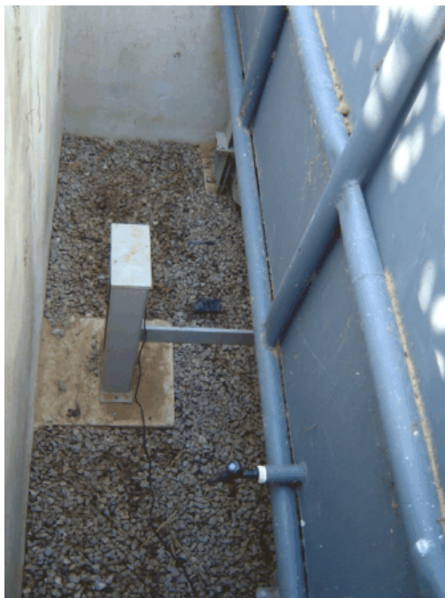
Figura 6 – Torneira instalada na lateral inferior do lisímetro para drenagem da água percolada.
