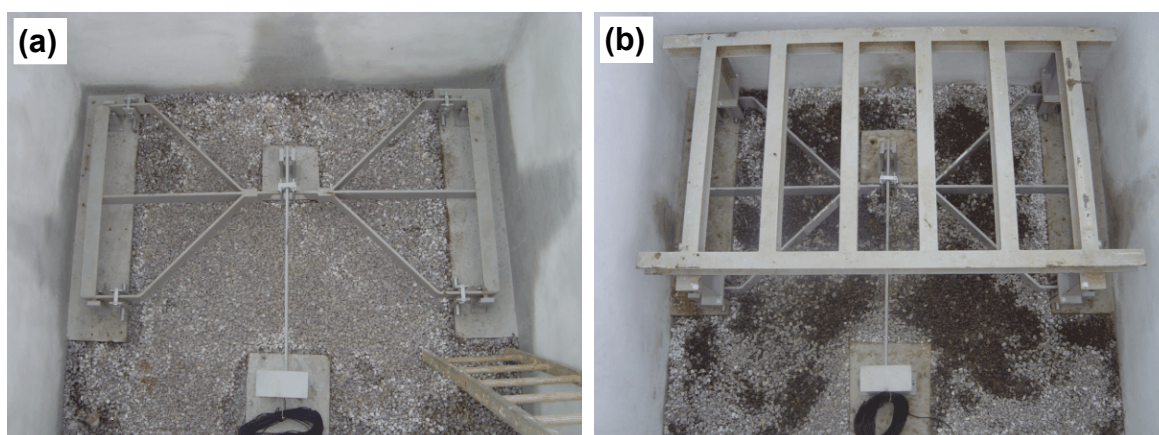
Figura 4 – Sistema de balança constituída (a), na parte superior, por um quadro metálico para sustentação da caixa lisimétrica (b).
