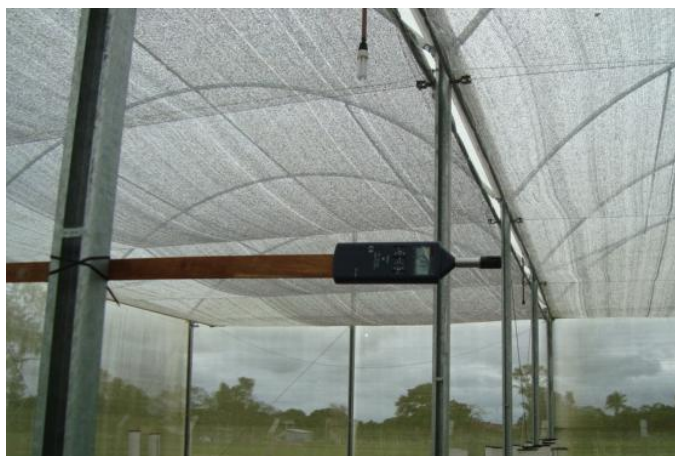
Figura 2. Termohigrômetro instalado no interior da casa-de-vegetação
