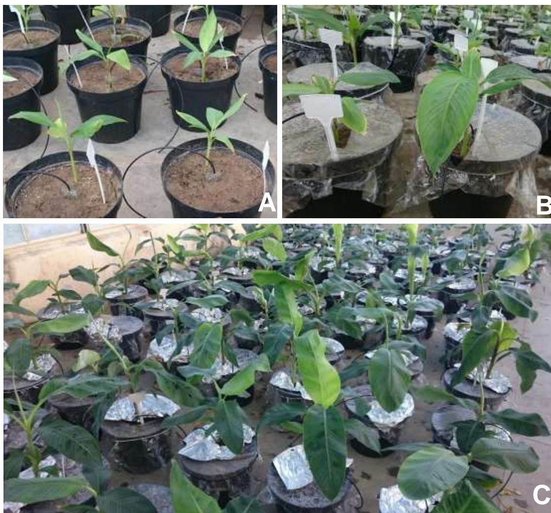
Figura 1. A) Instalação das sondas de TDR; B) Vedação dos vasos com plástico transparente; C) Vedação dos vasos com plástico transparente e papel alumínio. Fonte: Alice Lichs Marssaro.
