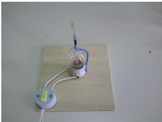
Base com soquete e plugue (esquerda) e base com o fio de cobre contornando a lâmpada (direita). Fonte da imagem: autores
