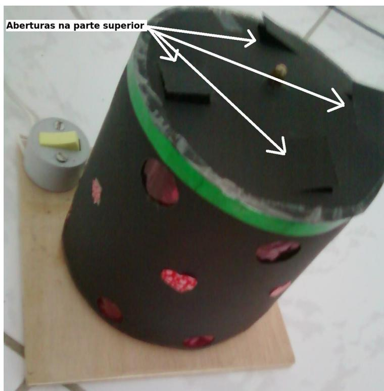
Montagem do cilindro com detalhe para as aberturas na parte superior. Fonte da imagem: autores
