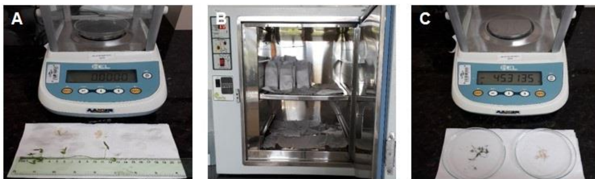
Figura 2. Fases do procedimento da avaliação de Manihot spp : Determinação do peso da massa fresca (A); acondicionamento dos materiais vegetais em estufa a 70 °C (B) e pesagem da massa seca (C) Fotos: Jucieny Ferreira de Sá.
